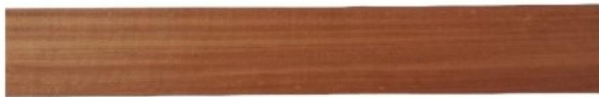
Il Mogano Sapelli è legno pregiato molto utilizzato in falegnameria per caratteristiche di resistenza e stabilità. Ideale per interno e per esterno.
