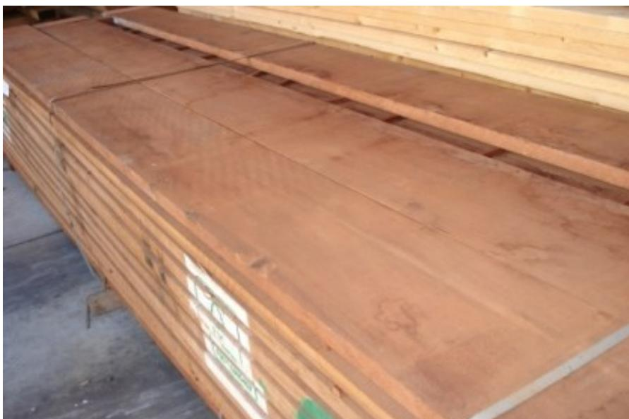
Il Mogano Sapelli è legno pregiato molto utilizzato in falegnameria per caratteristiche di resistenza e stabilità. Ideale per interno e per esterno.
