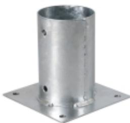
Portapilastro Tondo a Bicchiere Zincato a caldo. Con rialzo integrato e fori interni per consentire il deflusso dell'acqua. Diametro 120 mm.
