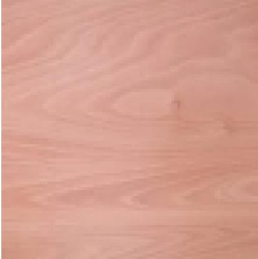
I listelli in legno di Okoumè sono forniti grezzi non piallati. Larghezza mm 52. Spessore da 10 a 80 mm. Lunghezza mm 2850.
