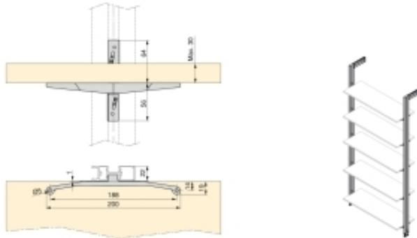
Set di supporti in zamak per uno scaffale in legno. Il montaggio viene eseguito sul profilo, componendo così la struttura modulare Zero da voi preferita.
