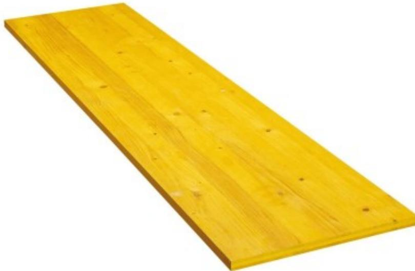
Il pannello per armatura è disponibile nella misura 50 x 250 cm. È costituito da tre strati di legno incollati fra loro. I due strati esterni in senso longitudinale e quello interno in direzione trasversale. Il pannello a tre strati LANA contribuisce a ridurre i costi delle casseforme, poiché la sua qualità consente di riutilizzarlo più e più volte; offre uno dei rapporti qualità/prezzo migliori del mercato.
