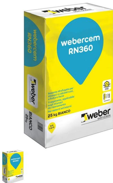
Rasante idrofugato per intonaci o calcestruzzo, a finitura liscia, di colore bianco, per esterni ed interni. • Traspirante, applicabile sugli intonaci da risanamento; • Grande lavorabilità e facilità di ripresa; • Ottima adesione anche su calcestruzzo e solai predalles. Colore Bianco. Sacco da 25 kg.
