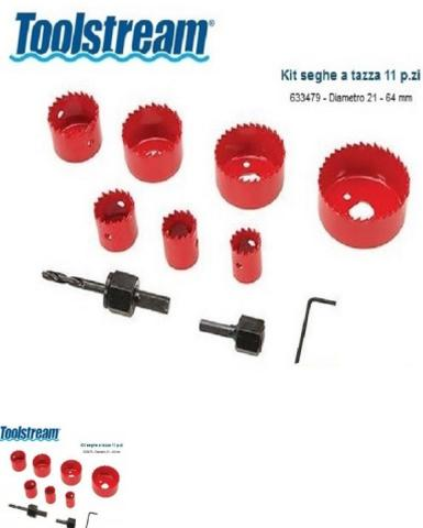
Seghe a Tazza per Legno Set 11 Pezzi da 21 mm a 64 mm; Le seghe sono realizzate in acciaio brunito a corpo unico; Ideali per forare legno, plastica, cartongesso; Profondità di taglio 22 mm; Il Set Include: 6 tazze per fori  $\varnothing$  51, 57, 67, 76, 89, 102 mm; 1 punta per centrare; 1 mandrino; 1 chiave d'uso.
