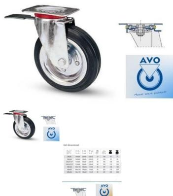
Ruote con rivestimento in gomma e flange in acciaio. Anello in gomma piena. Flange in acciaio stampato zinco-cromato. Mozzo su gabbie a rulli. Con supporto girevole e con freno. Disponibile con diametro: 80 - 100 mm
