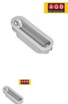
Incontro in nylon con bordo tondo, larghezza 18 mm, lunghezza 57 mm. Design minimalista e lineare che lo rende quasi impercettibile sul telaio della porta. Registrabile in pressione fino a 1,5 mm mediante rotazione di 180° dell'incontro.
