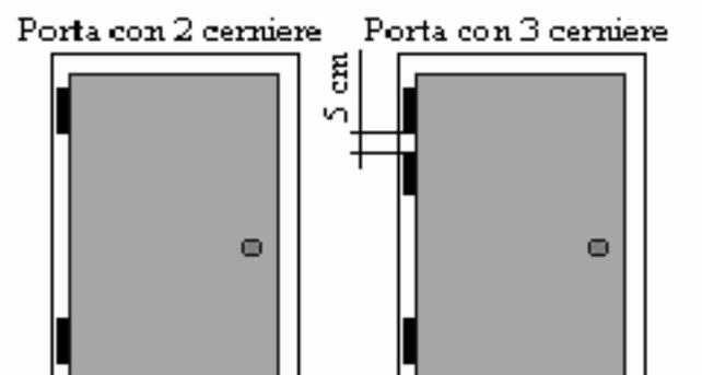
**ATTENZIONE:** per il montaggio di 3 cerniere raccomandiamo di montare n. 2 in alto distanziandole max 5 cm. vedi disegno
