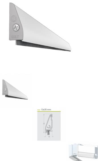
Sistema ideato per l'installazione anche su porte già esistenti dove sia necessario inserire una soglia drenante. Il sistema può essere completato con l'utilizzo del gocciolatoio Ulisse Drip che grazie alla spazzola in polipropilene con pinna contribuisce a aumentare la tenuta dell'acqua. Facile da montare. Disponibile in tre lunghezze: 103 - 133 - 163
