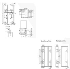
Cerniere invisibili con un sistema funzionale completamente occulto ideale da installare su ante scorrevoli non battenti della casa. Con offset da 14 mm,
