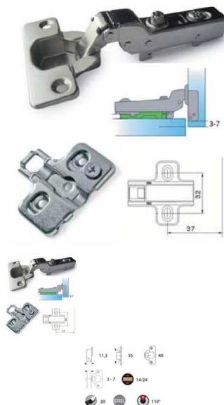
Cerniera idraulica con clip adatta al montaggio di ante a filo esterno. Basetta compresa.
