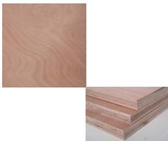
Il multistrato di Okoumè è un pannello costituito interamente da strati in legno di Okoumè il cui incollaggio è effettuato con colla fenolica, che garantisce una ottima tenuta in condizioni di forte umidità.
