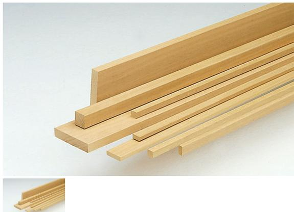
**CARATTERISTICHE** Descrizione generale: colorazione dal bianco crema al giallo chiaro; fibratura solitamente intrecciata, tessitura abbastanza fine e uniforme. Possibile presenza di tracce di minerale che passano a striature marroni. Impieghi: cornici da quadro e per mobili, corrimani interni, lati e rivestimenti di cassetti, falegnameria interna, tavole armoniche senza cursori per organi, modellatura; compensati, impiallaccature decorative. Uso: interno
