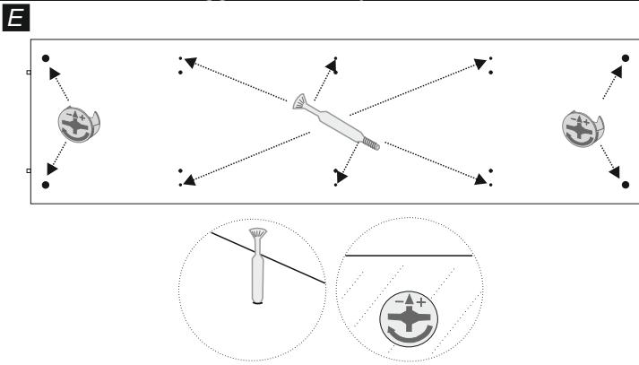
Come spiegato in fig A e C, inserire i perni per eccentrico (8) e gli eccentrici (9) sul fianco (6). Avvitare i perni (8) sino a fine corsa.
