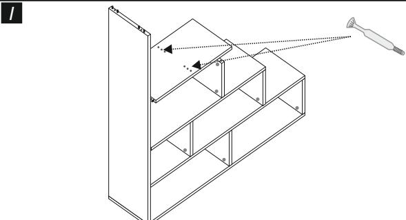
Inserire un fianco B (7) sulla base C (3). Chiudere con la base D (4), infilandola prima sul fianco A (8) e poi sui fianchi B (7) con il lato con i perni (8) fissati. Sull'altro lato di questa base, inserire i perni per eccentrico (8). Avvitarli sino a fine corsa.
