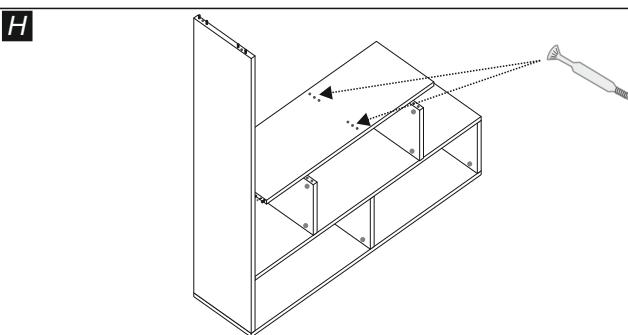
Inserire due fianchi B (7) sulla base B (2). Chiudere con la base C (3), infilandola prima sul fianco A (8) e poi sui fianchi B (7) con il lato con i perni (8) fissati. Sull'altro lato di questa base, inserire i perni per eccentrico (8). Avvitarli sino a fine corsa.
