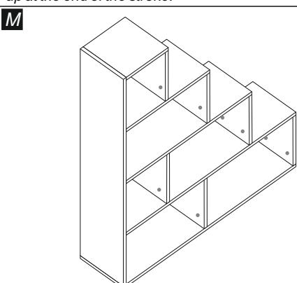
Chiudere con il coperchio (5), infilandolo sui fianchi A (8) e B (7) con il lato con i perni (8) fissati.
