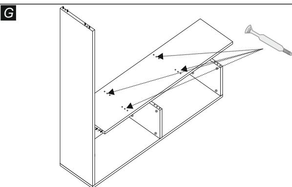
Chiudere con la base B (2), infilandola prima sul fianco A (8) e poi sui fianchi B (7) con il lato con i perni (8) fissati. Sull'altro lato di questa base, inserire i perni per eccentrico (8). Avvitarli sino a fine corsa.
