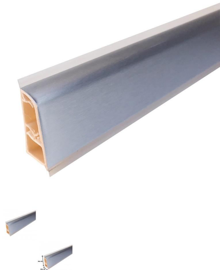
Disponibile in lunghezza cm 100, cm 200, cm 300 e cm 400. Usata per chiudere il top sulla parete della cucina evitando infiltrazioni. L' alzatina è provvista di un alloggiamento interno utile al passaggio di eventuali cavi elettrici. Struttura in PVC e frontalino in Alluminio. Sezione mm 20 x H 40.
